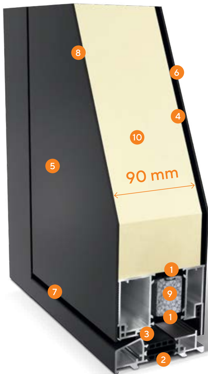
2 Izolowany próg –przekładki termiczne, poliamidowe w progu
